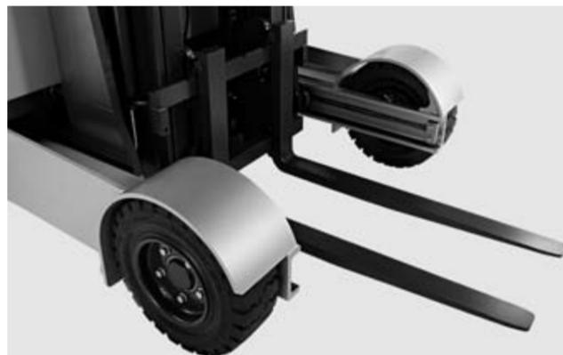
Superelastik-Bereifung mit Radschutz für mehr Sicherheit
