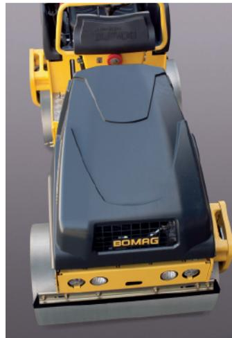
Rouleaux à dégagement latéral grâce à des cylindres à accrochage unilatéral, avec décalage de 60 mm.
